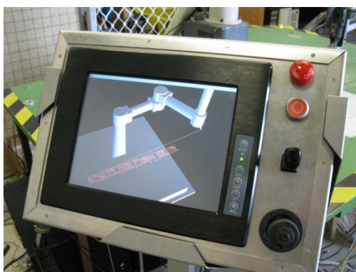
3-15. ábra A tanítópult működés közben
