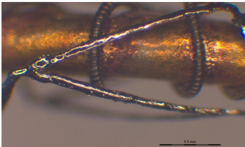
86. ábra. Szent tengelye mentén átmenő megfogás kombinált huzalanyaggal, kétoldali árambevezetéssel polírozott sztent sztereomikroszkópos képe
