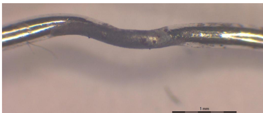
28. ábra. Az alumínium huzal az elektropolírozást követően
