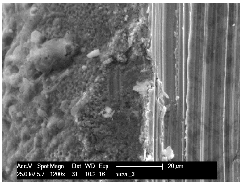
34. ábra. A vörösréz huzal az elektrolyzást követően, kiválások (bal), alapanyag (jobb)
