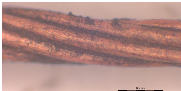
35. ábra. A vörösréz huzal az elektrolyzást követően
