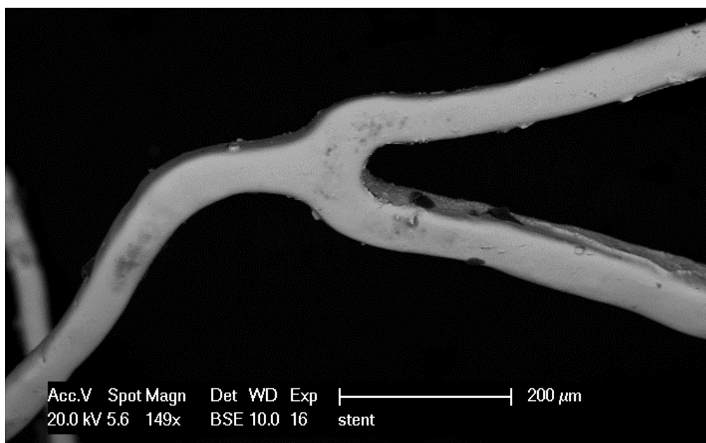
93. ábra. 0,3 amperes áramerősséggel elektropolírozott sztent elektronmikroszkópos képe
