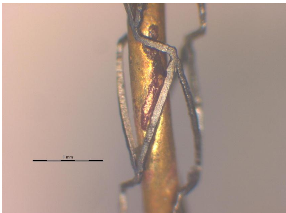
77. ábra. Sztent tengelye mentén átmenő megfogás egyoldali árambevezetéssel polírozott sztent, rosszul polírozott rész
