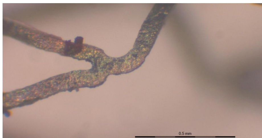
29. ábra. Az alumínium huzallal polírozott sztent
