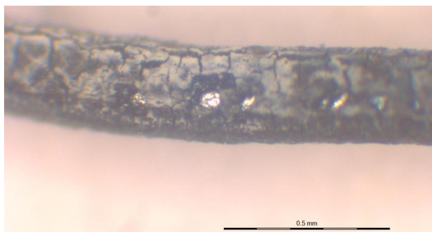
31. ábra. A molibdén huzal az elektropolírozást követően
