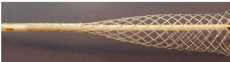
11. ábra. A csőből kinyomódó sztent feltágulása
