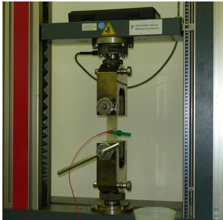
59. ÁBRA EGY BEHELYEZETT PRÓBATEST KÖZVETLENÜL A MÉRÉS MEGKEZDÉSE ELŐTT, AKUSZTIKUS EMISSZIÓS SZENZORRAL
