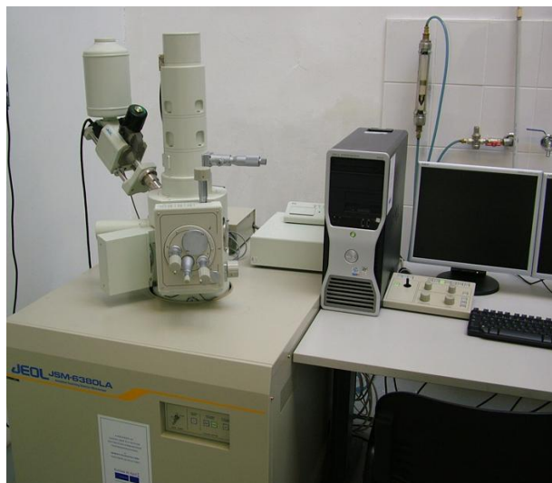
19. ábra: Jeol JSM 6380LA típusú pásztázó elektronmikroszkóp
