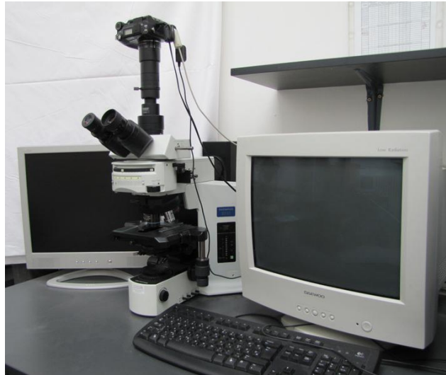
18. ábra: Olympus BX 51M típusú optikai mikroszkóp
