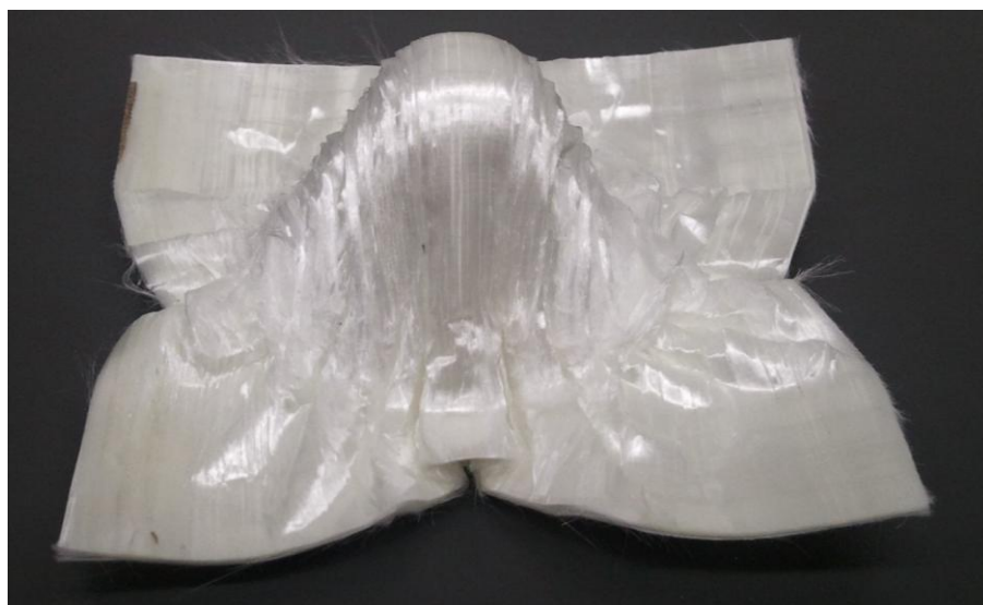
43. ábra: CP PET próbatest ejtődárdás vizsgálat után
