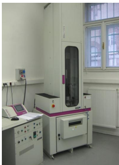
24. ábra: CEAST Fractovis 7685 típusú berendezés
