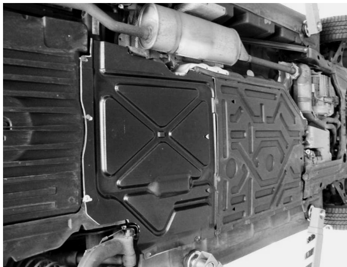
4. ábra: Önerősített PP kompozit autóipari alkalmazása [12]
