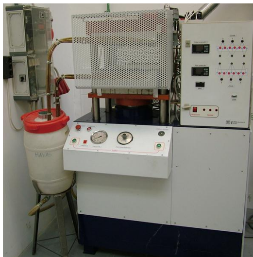
12. ábra Schwabenthan Polystat 300 S típusú présgép
