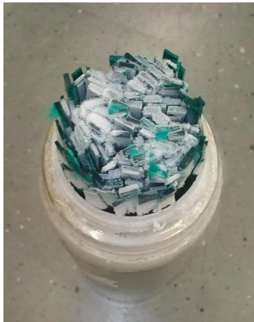
13. ábra: PP kompozit lap folyékony nitrogénben
