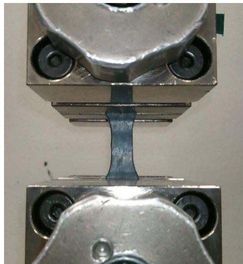
23. ábra: Piskóta próbatest mérési elrendezése
