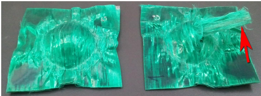
41. ábra: Szabványos próbatest ejtődárdás vizsgálat után
