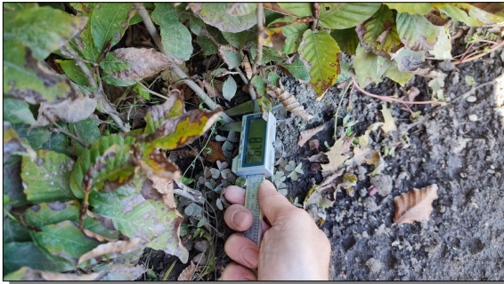
7. ábra: A csemeték gyökfő átmérőjének mérése digitális tolómérővel.
