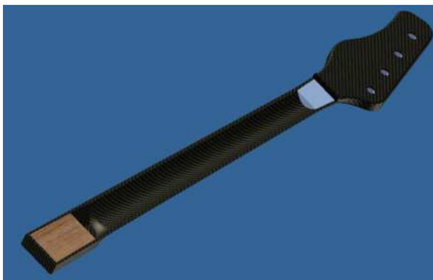
36. ábra: A nyakban elhelyezett fainzert szemléltetése
