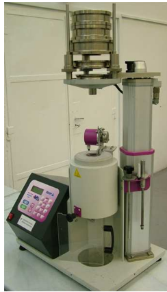
26. ábra CEA 7027.000 típusú, számítógép-vezérlésű kapilláris viszkoziméter
