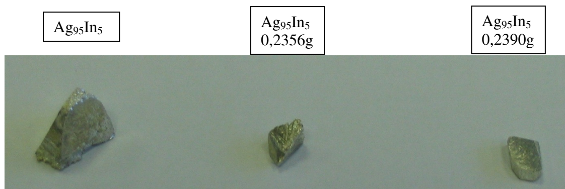
29. ábra : \text{Ag}_{95}\text{In}_5 öntecs darab és méréshez előkészített minták
