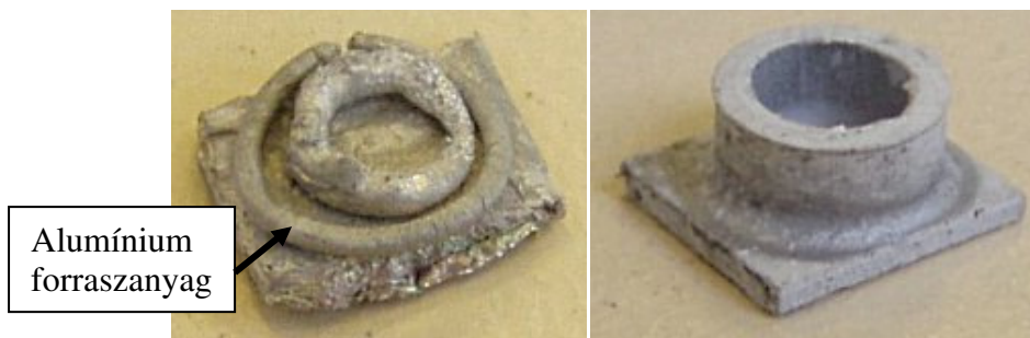
24. ábra: Alumínium lézeres forrasztása flux nélkül (bal) és fluxszal (jobb) [19]
