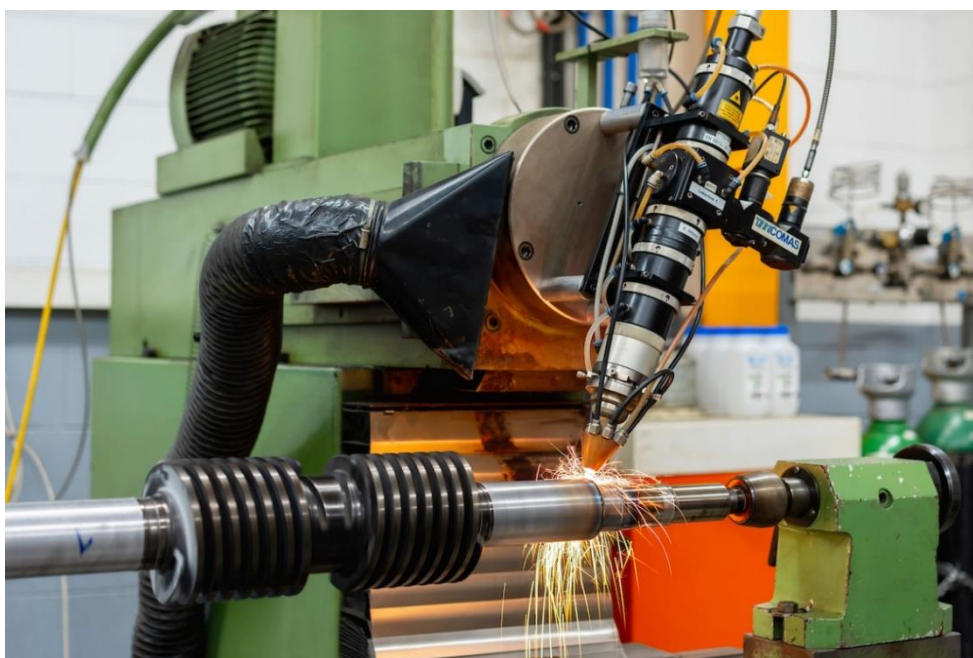
3. ábra Lézeres felrakóhegesztés a gyakorlatban
