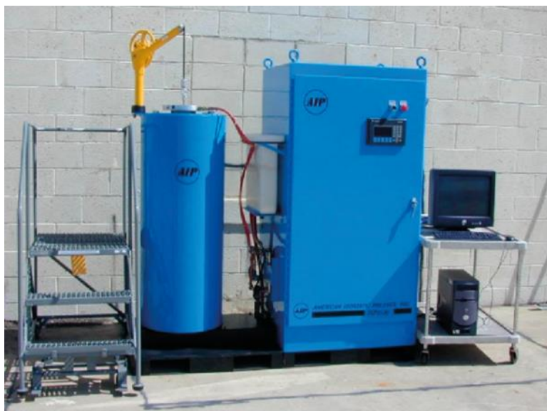
16. ábra HIP berendezés [28]
