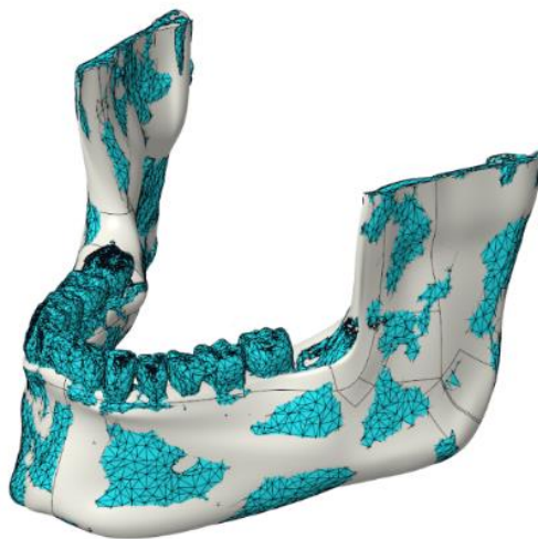
19. ábra: A CT felvétel és a NURBS görbékkel rekonstruált modell együtt
