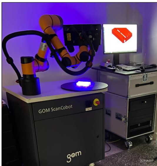
9. ábra Alkatrész bemérése GOM rendszerrel
