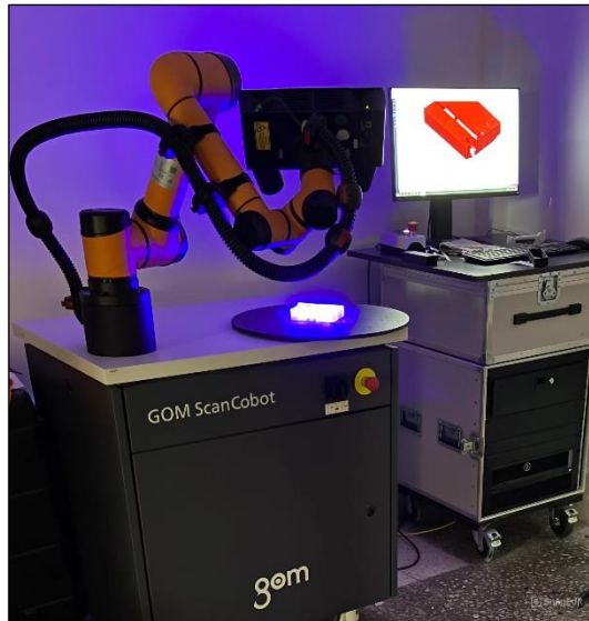
9. ábra Alkatrész bemérése GOM rendszerrel
