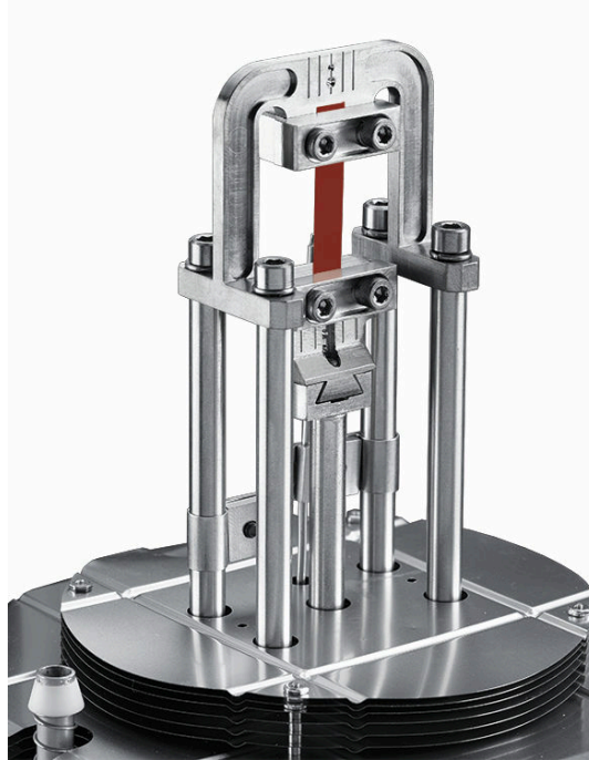
11. ábra: Dinamikus Mechanikus Analizátor DMA Q800 húzó befogó
