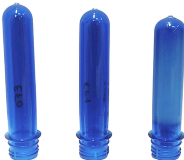
7. ábra: Balról jobbra az előmelegítetlen, egyszeresen és kétszeresen előmelegített előforma
