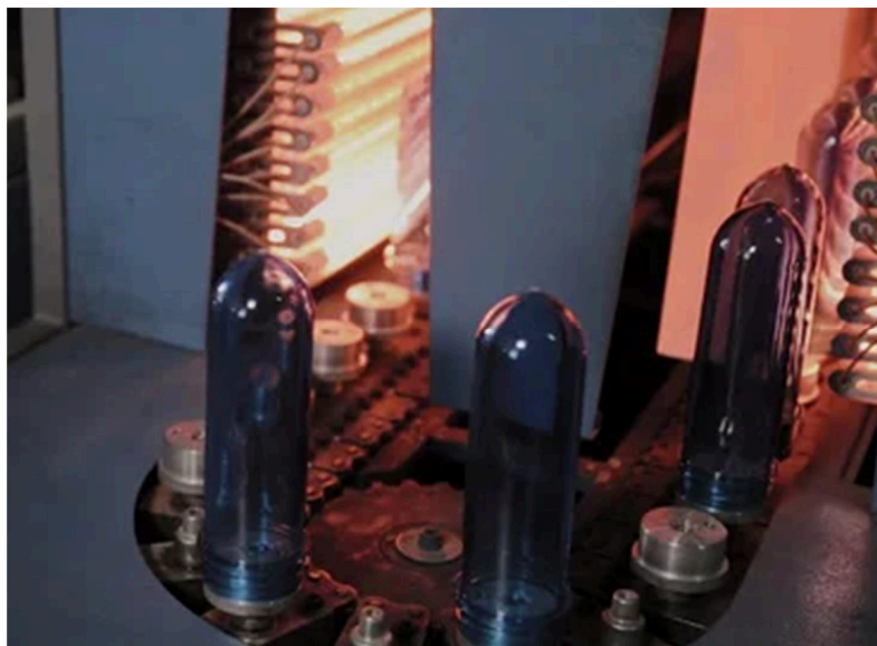
8. ábra: Előformák az előmelegítő sor megvezető szalagján[36]
