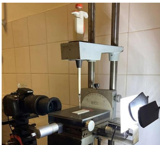
6. ábra: A felületen kialakított struktúrák nedvesítőképességének meghatározásához alkalmazott nyugvó csepp módszeres peremszög mérési rendszer
