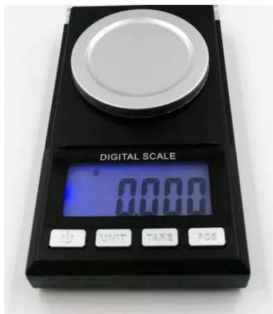
10. ábra: A méréshez használt mérleg, mérési pontosság 0,001 g.
