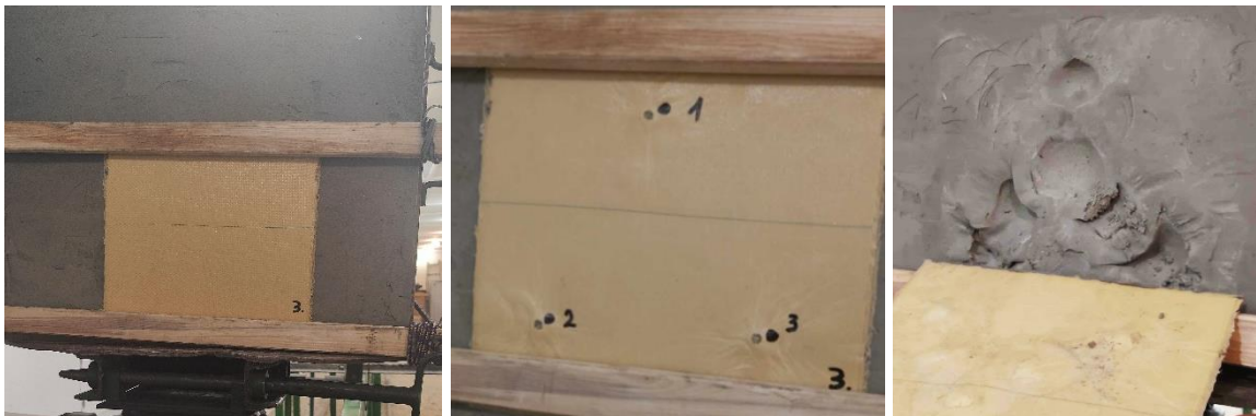
47. ábra – Harmadik próbadarab vizsgálata: próbadarab rögzítve (bal), harmadik lövés után (közép), lenyomatok (jobb)
