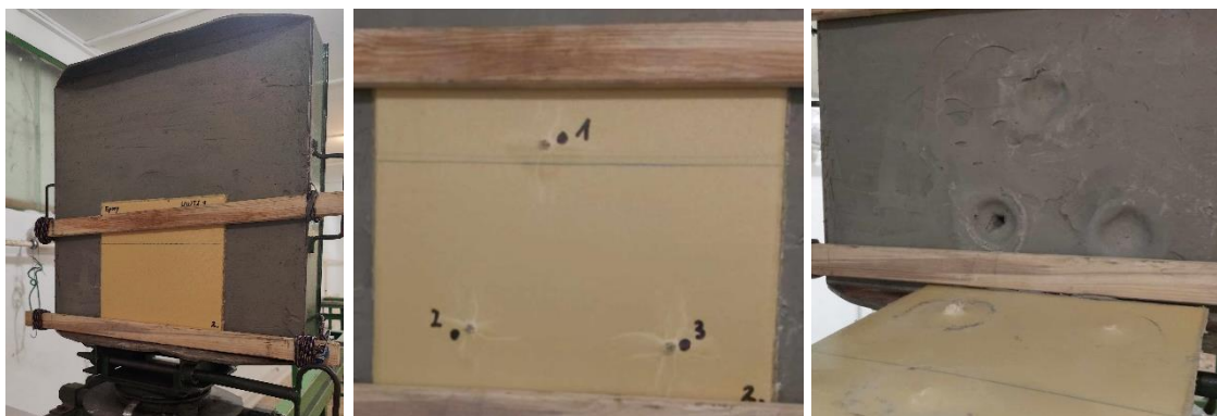
44. ábra - Második próbadarab vizsgálata: próbadarab rögzítve (bal), harmadik lövés után (közép), lenyomatok (jobb)
