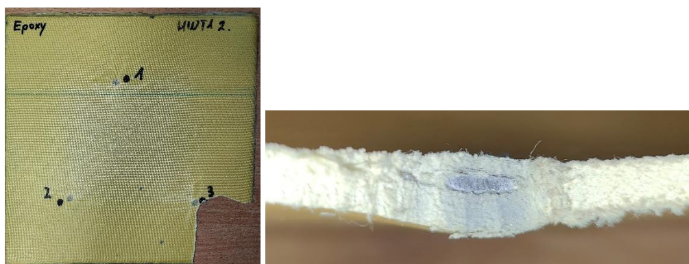
45. ábra – Az epoxy erősítésű anyag traumazónája kifűrészelve
