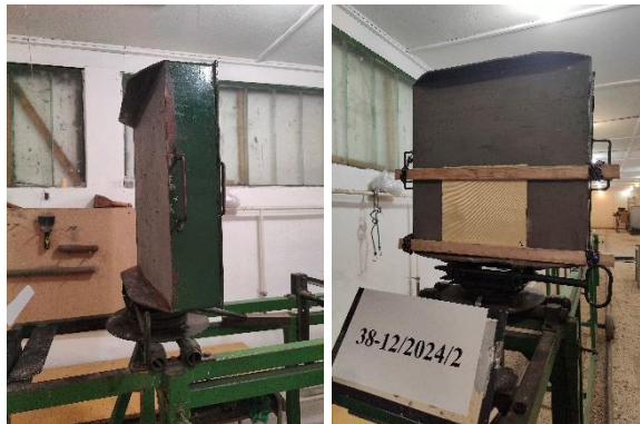
34. ábra – A próbadarabot tartó keret és gyurma a próbadarab rögzítése előtt (bal) és után (jobb)
