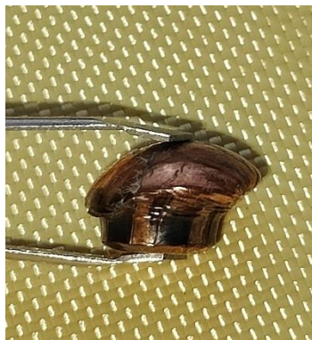
51. ábra – A pillanatragasztott anyagba csapódott lövedék
