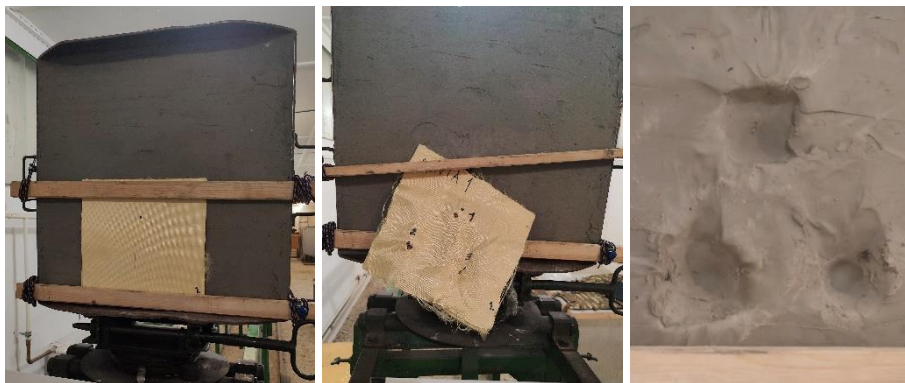
41. ábra – Első próbadarab vizsgálata: próbadarab rögzítve (bal), harmadik lövés után (közép), lenyomatok (jobb)
