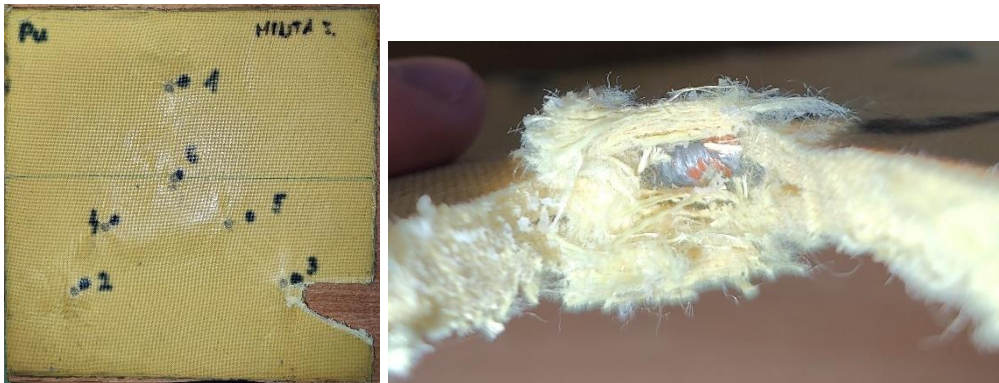
48. ábra – A poliuretán erősítésű anyag traumazónája kimetszve
