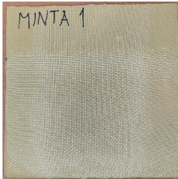
17. ábra – Pillanatragasztott anyagú próbadarab
