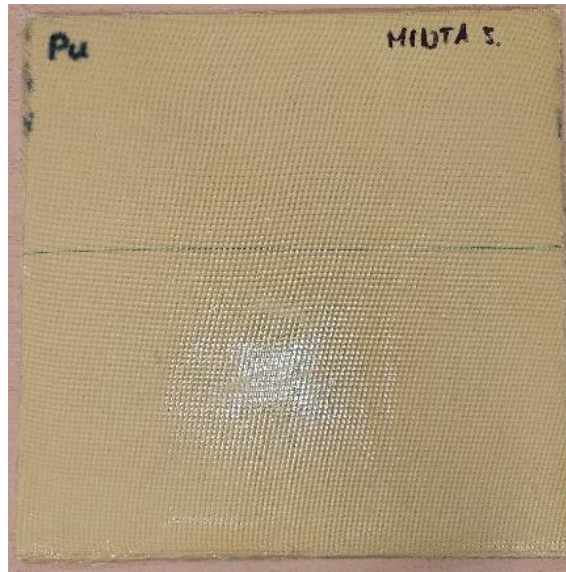
19. ábra – Poliuretán erősítésű próbadarab
