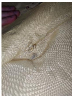
42. ábra – A pillanatragasztott anyag rétegei szétválasztva a traumazónában
