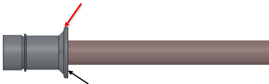
20. ábra A piros nyíllal jelölt felület a rögzítőkarom ellendarabja. A fekete nyíllal jelölt felület az a sík, amely a tokon felütközik a csőhátrasiklás leghátsó pontján.
