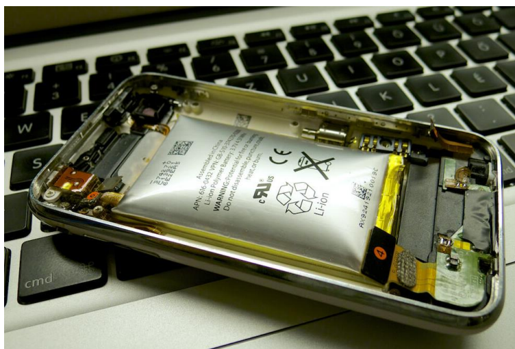
2.3. ábra: Felpúposodott akkumulátor [14]
