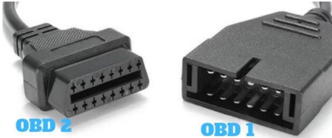
7.1. ábra: OBD I és OBD II csatlakozó [23]
