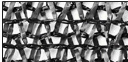
10. sz. ábra: Raschel típusú háló anyag (Mayerhofer és mtsai., 2015)
