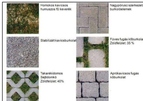
6. sz. ábra: Áteresztő burkolat típusok (Kaiser, 2020)
