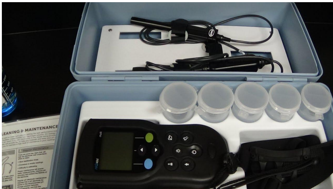
7. ábra: HQ40D hordozható digitális vezetőképesség mérő szondával (Forrás: Hach)
