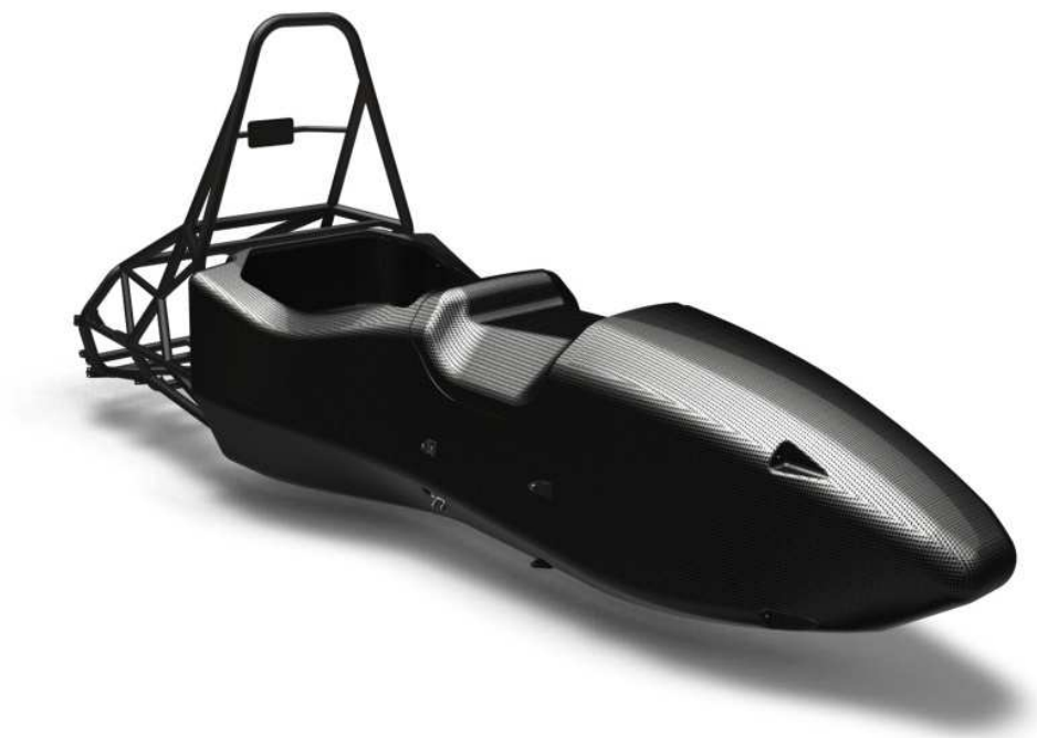
56. ábra A kész vázszerkezet
