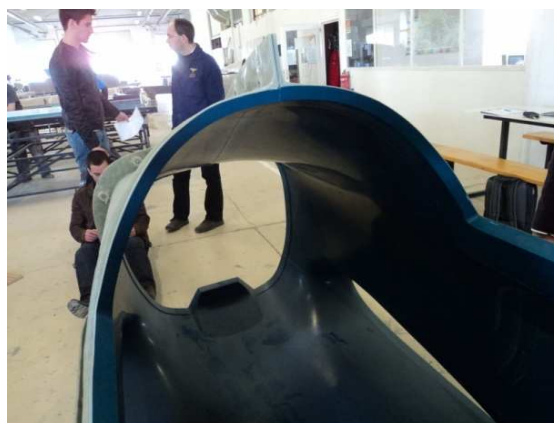
53. ábra Negatív szerszámok összeállítás után
