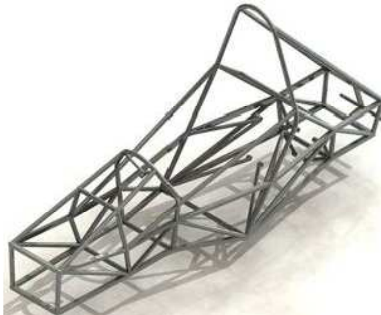
10. ábra Csővázas konstrukció
