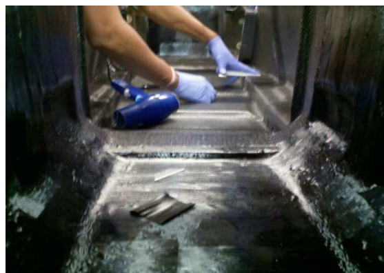
55. ábra Laminálás a negatív szerszámokra
