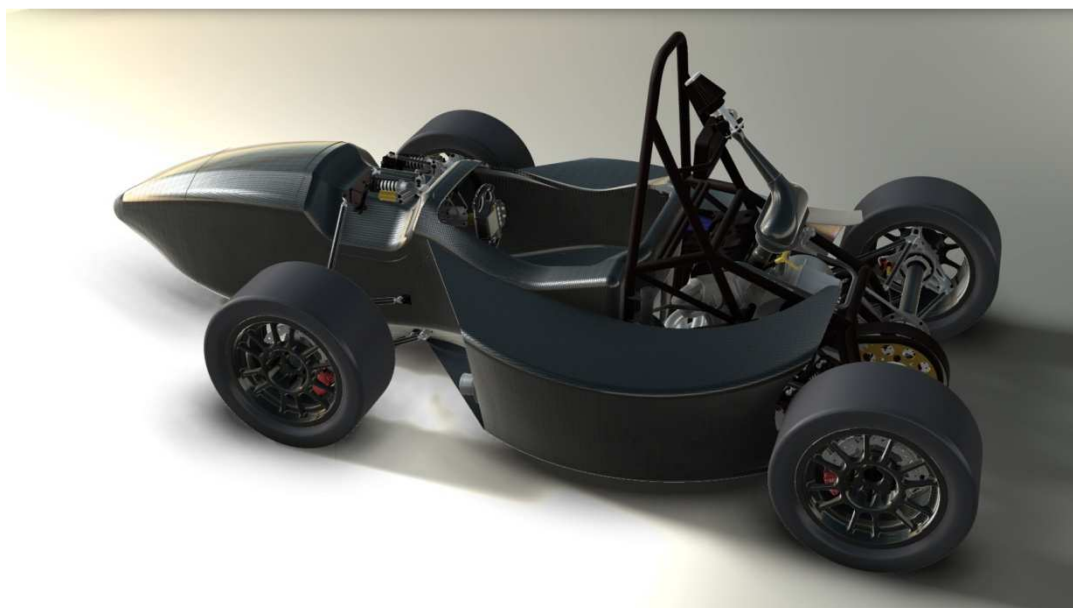
57. ábra A kész monocoque és a versenyautó többi részegysége. A részegységek a BME FRT Junior csapata által lettek megtervezve.
