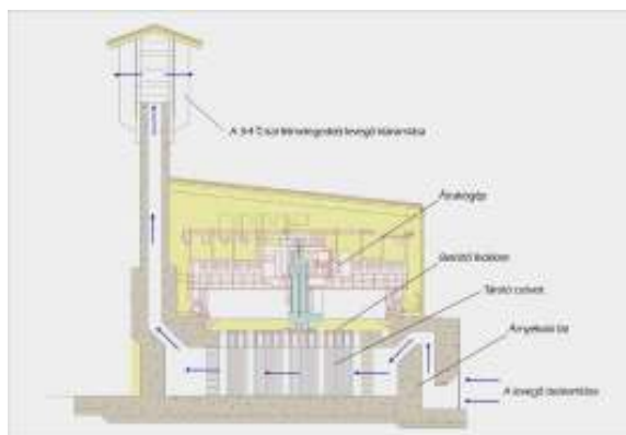
17.-18. kép: KKÁT keresztmetszet [16]
