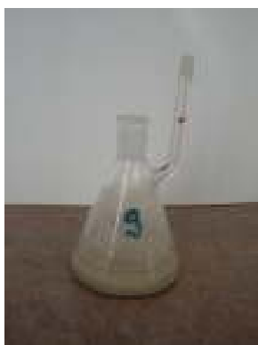
32.-33.-34. kép: Piknométer és C 2 HCl 3 használata a fajlagos felület meghatározása során
