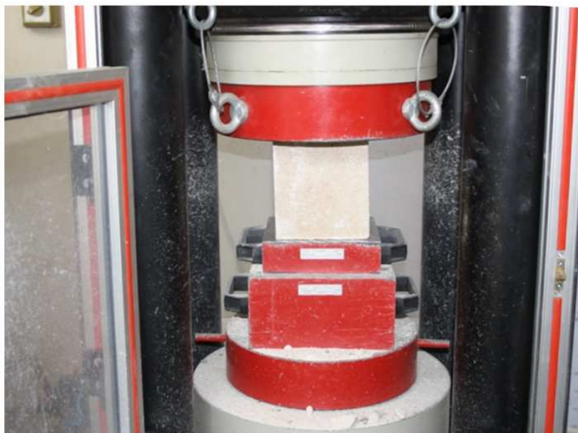
3.3 ábra: Nyomószilárdság mérése betonon
