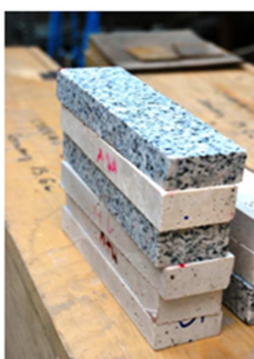
5.5. ábra – Kő próbatestek és a hajlító-húzószilárdság vizsgálat
