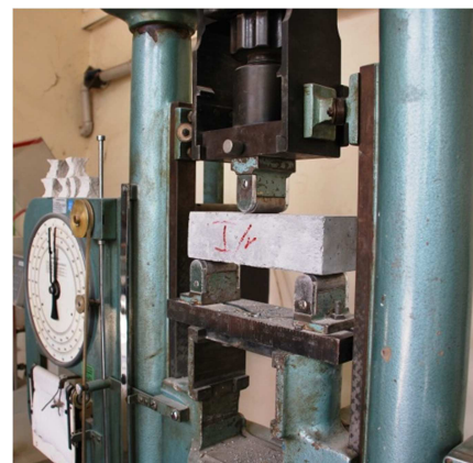
5.4. ábra – Hajlító-húzó vizsgálat beton próbatesten
