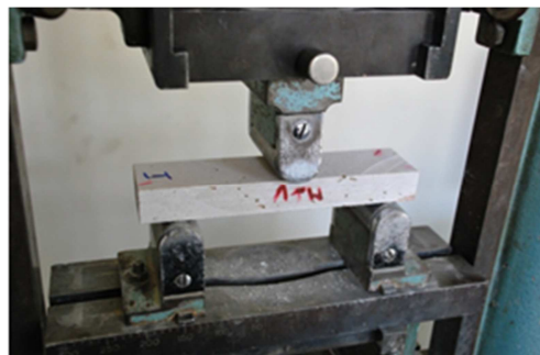
5.5. ábra – Kő próbatestek és a hajlító-húzószilárdság vizsgálat
