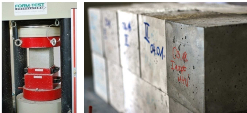
5.2. ábra – Nyomószilárdság vizsgálatok (terhelőgép és próbatestek)
