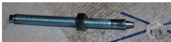
3.16. ábra – Acél szárszakadás a csökkentett keresztmetszetben
