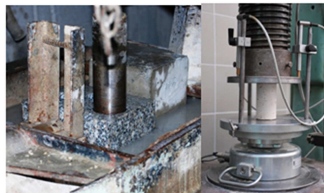
5.3. ábra – Nyomószilárdság vizsgálatok (próbatest kialakítás magfúrással és a terhelőgép
