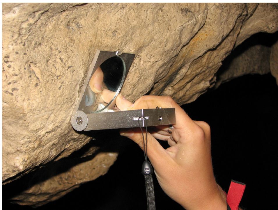
3. kép. Tagoltságok vizsgálata geológus kompasszal
