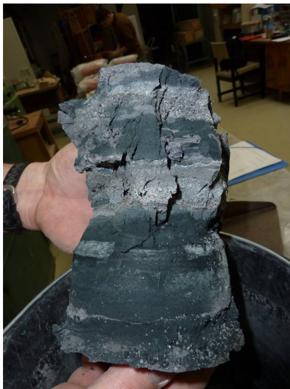
181. ábra. A pernyezagy réteges szerkezete
