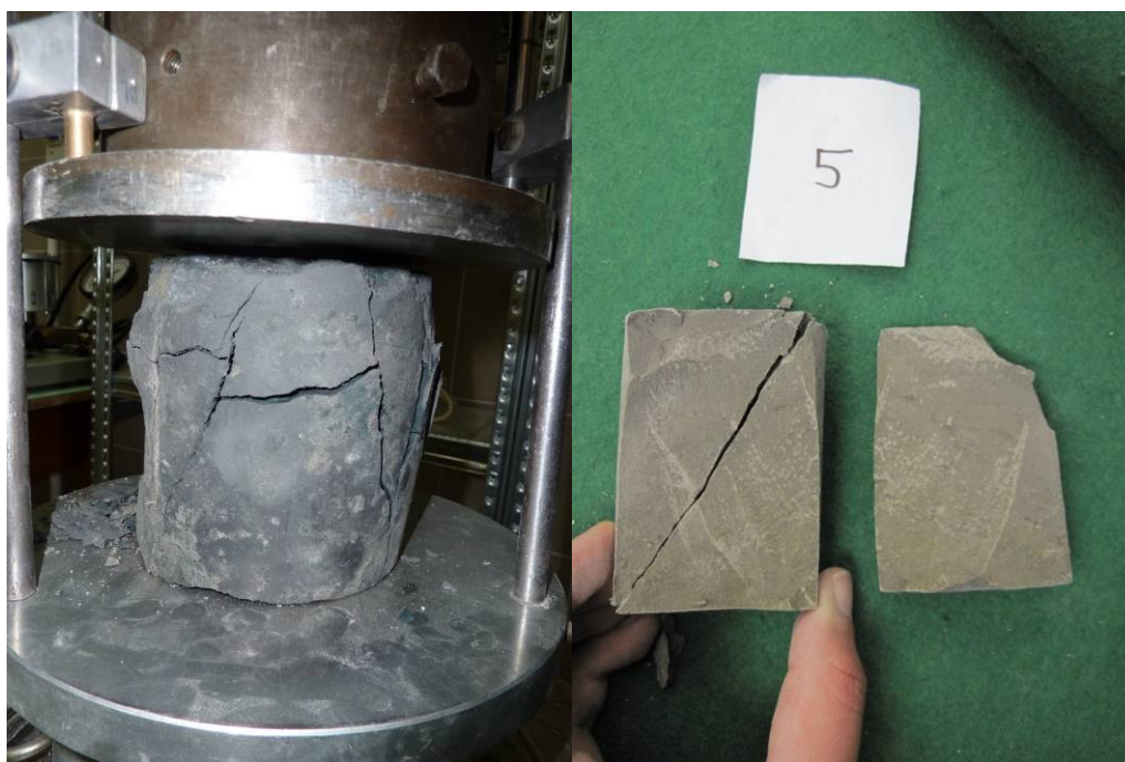
25. ábra. Pernye és megszilárdult szürke kiscelli agyag törésképe
