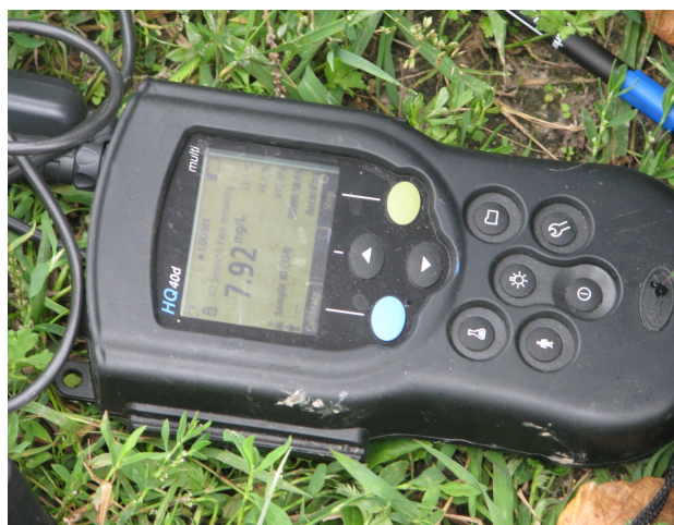
28. ábra: Oldott oxigén-koncentráció és -telítettség mérő műszer (fotó: Szilágyi)
