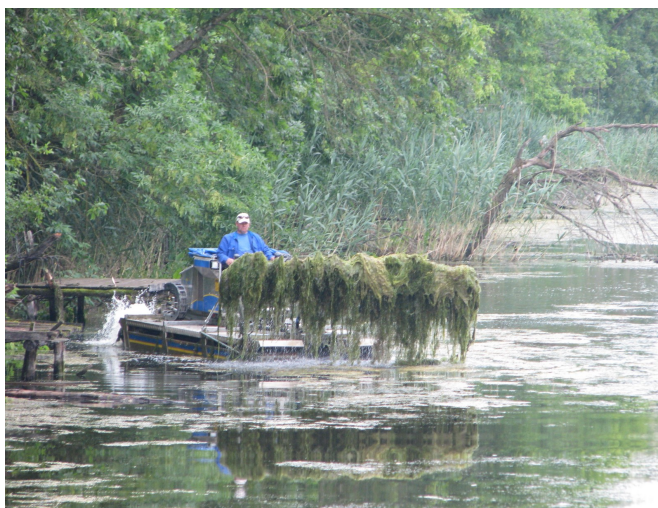
40. ábra: Truxor hínárvágó munkában (fotó: Vágvölgyi)
