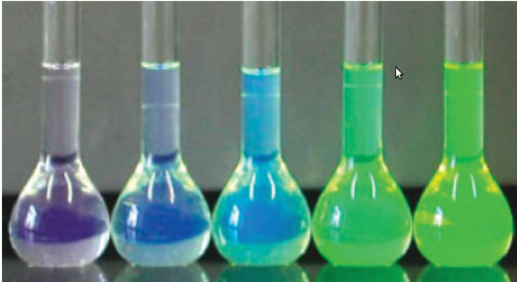
1.2. ábra. CdSe/CdS core/shell nanokristályokat tartalmazó koloidos oldatról készült fénykép. A nanokristályok magjának átmérője 1,2 nm és 1,5 nm között változik.[5]
