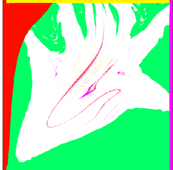
30. ábra: A négy partéltől 50m szélességben és teljes 2m-es mélységben elhelyezett lékbe érkező részecskék kezdeti pozíciója. Az ábrák jobbról balra és fentről lefele haladva 8 órás periódus idő esetén, z=-0,7 -1,0 -1,3 -1,6 és -1,9 m mélységű síkokat mutatják. A részecskék száma szintenként 440 ezer.
