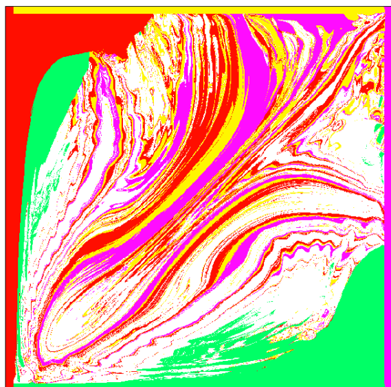
29. ábra: A négy partéltől 50m szélességben és teljes 2m-es mélységben elhelyezett lékbe érkező részecskék kezdeti pozíciója. Jobbról balra és fentről lefele haladva a z=-1,3 m síkot tekintve sorban a 2,4,6,8,12 órás periódusidőhöz tartoznak. A részecskék száma szintenként 440 ezer.
