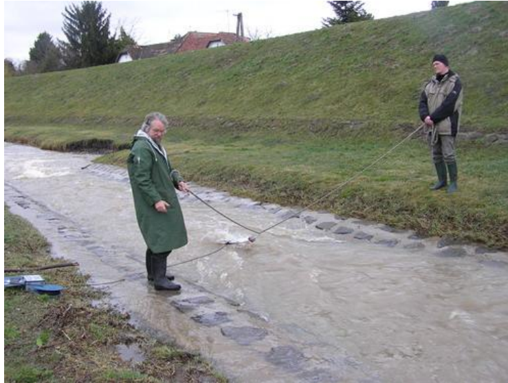
9. kép: Sikertelen szózasos vízhozam-mérés a torkolatnál, nagyvíz miatt kötéllel rögzített mérőműszerrel 2011. 03. 18-án.
