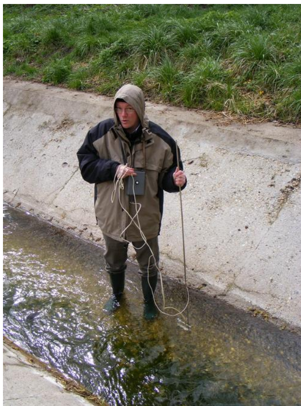
6. kép: Forgósárnyas mérés a vízmércénél, 2011. 04. 14.
