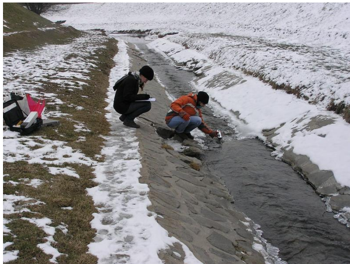
7. kép: Vízhozam-mérés sózással a torkolatnál, 2011. 02. 02.
