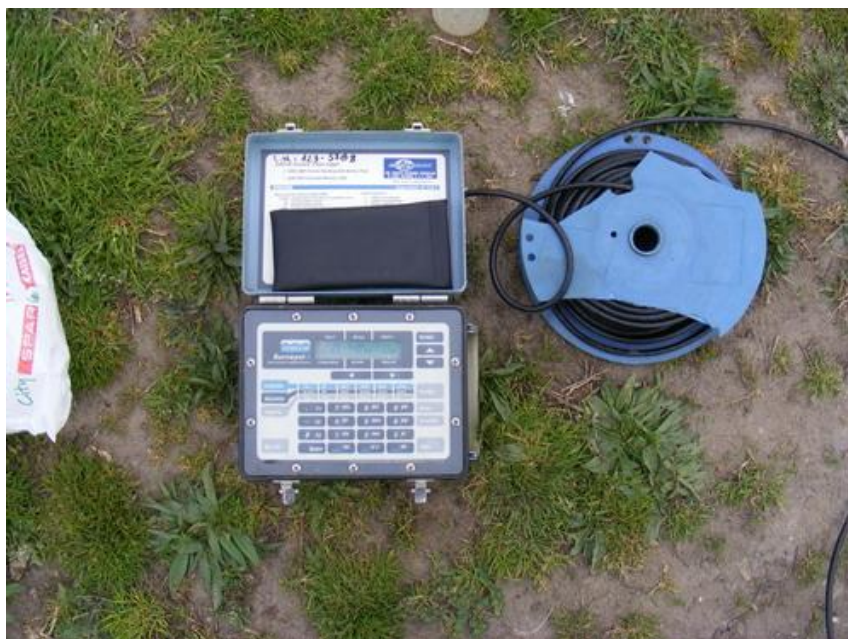
2. kép: Kahlisco Surveyor 3 mérőműszer adatrögzítő része
