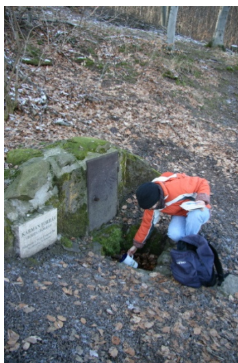
4. kép: Vízhozam-mérés a Kármán-forrásnál, 2011. 01. 23.
