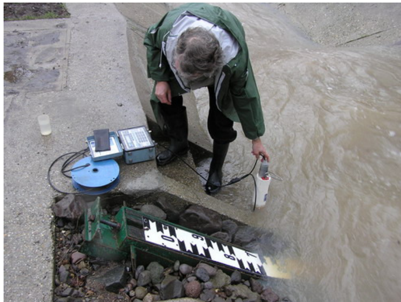
10. kép: 2011. 03. 18., nagyvíz a vízmércénél, mérés Kahlisco Surveyor 3 mérőműszerrel.
