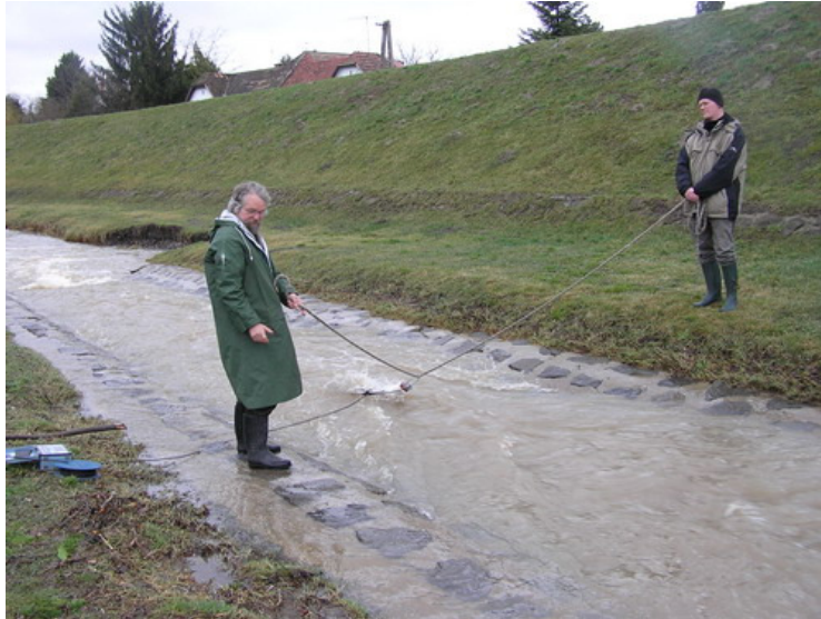
9. kép: Sikertelen sózásos vízhozam-mérés a torkolatnál, nagyvíz miatt kötéllel rögzített mérőműszerrel 2011. 03. 18-án.
