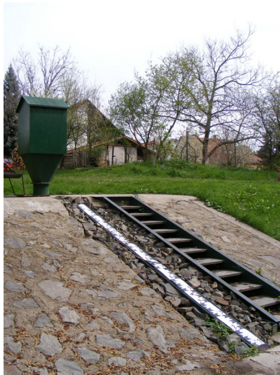
12. kép: Lapvízmérce a Bükkös-patakon
