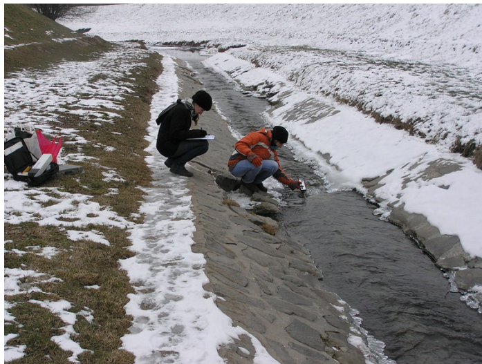
7. kép: Vízhozam-mérés sózással a torkolatnál, 2011. 02. 02.
