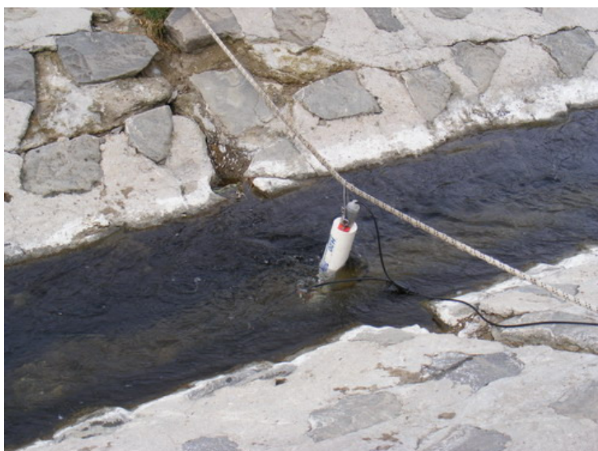
3. kép: Kahlisco Surveyor 3 érzékelő része
