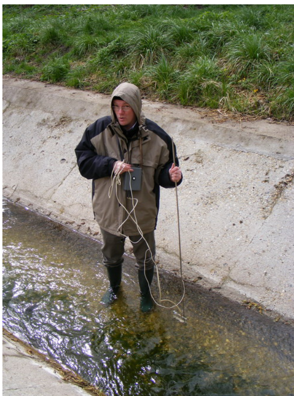
6. kép: Forgószárnyas mérés a vízmércénél, 2011. 04. 14.
