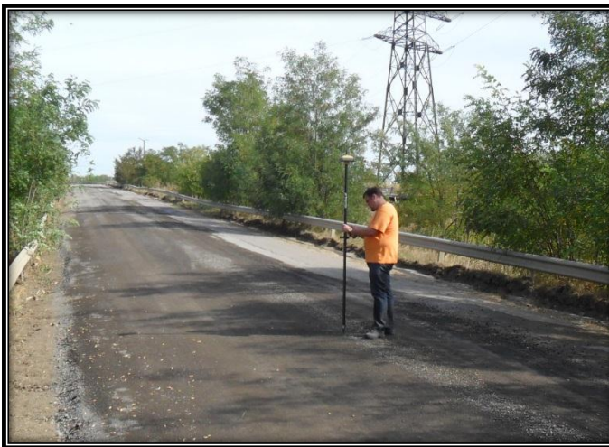
5. kép: A nagy pontosságú RTK GPS mérés gyakorlati egyszerűsége
