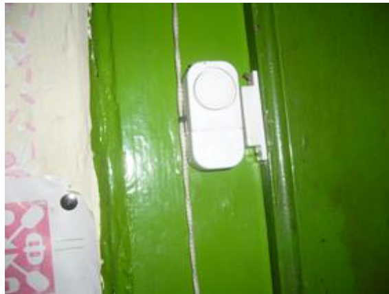
36. ábra: Elektronikus nyitásérzékelő
