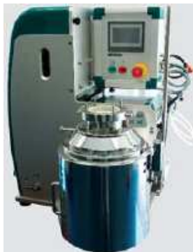
8. ábra A malom töltési, ill. karbantartási pozíciója
