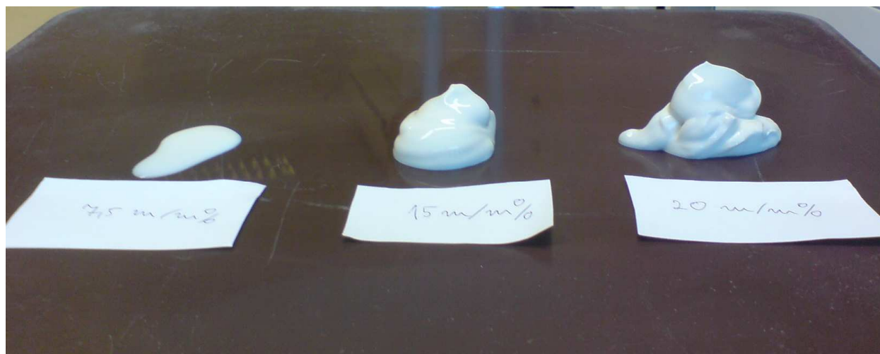
14. ábra A 7,5; 15 és 20 m/m %-os feladású kísérletek termékeinek összehasonlítása
