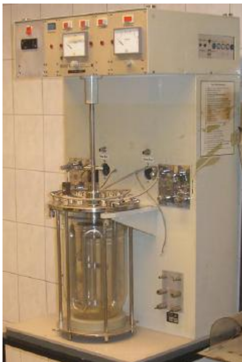
8. ábra: A biogáz vizsgálatához alkalmazott dinamikus berendezés (Dr. Bokányi L. és Varga T., 2011)
