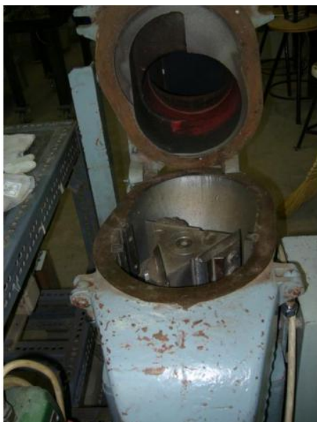
3. ábra: Függőleges tengelyű vágómalom (Dr. Bokányi L. és Varga T., 2011)
