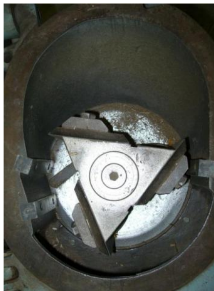
3. ábra: Függőleges tengelyű vágómalom (Dr. Bokányi L. és Varga T., 2011)
