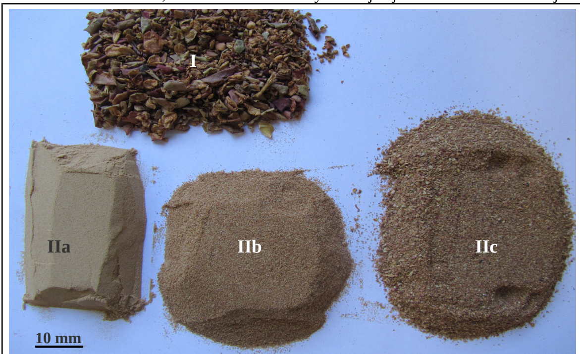
16. ábra. A feladás (I) és az őrlés termékei (IIa: 250 \mu\text{m} alatti, IIb: 150-400 \mu\text{m} közötti és IIc: 400 \mu\text{m} fölötti szemcsemérettel)
