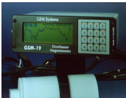
8. ábra: Az OVERHAUSER proton precessziós magnetométer (fotó: Szabó Norbert Péter)
