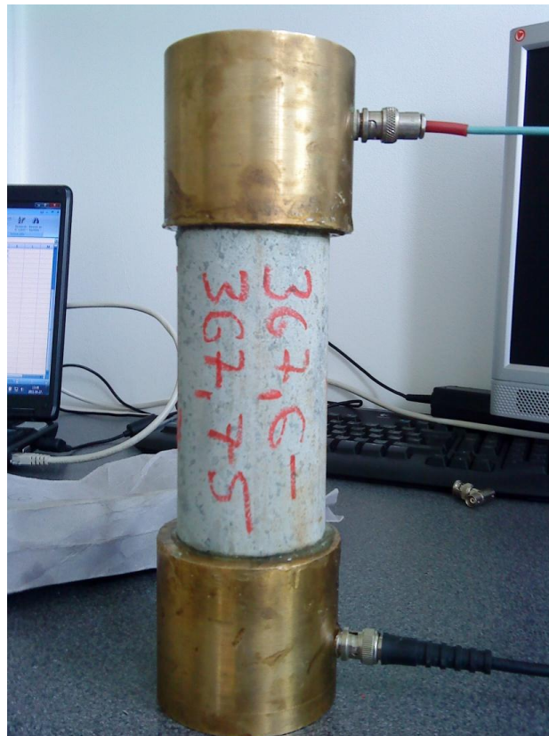
4. ábra. Longitudinális hullám terjedési sebességének mérése szeizmoszkóppal.
