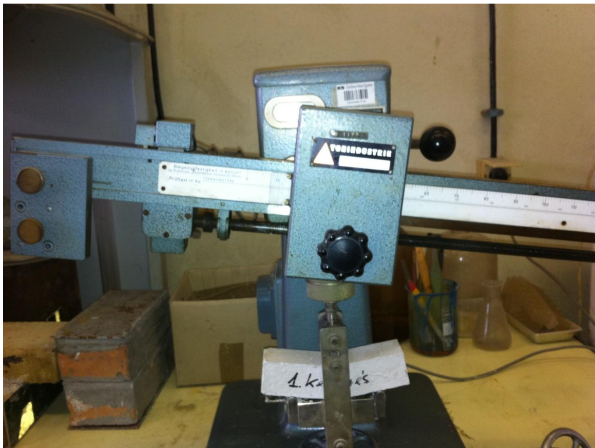
14. ábra A habarcs hasábok hasító-húzószilárdság vizsgálatához használt törőgép
