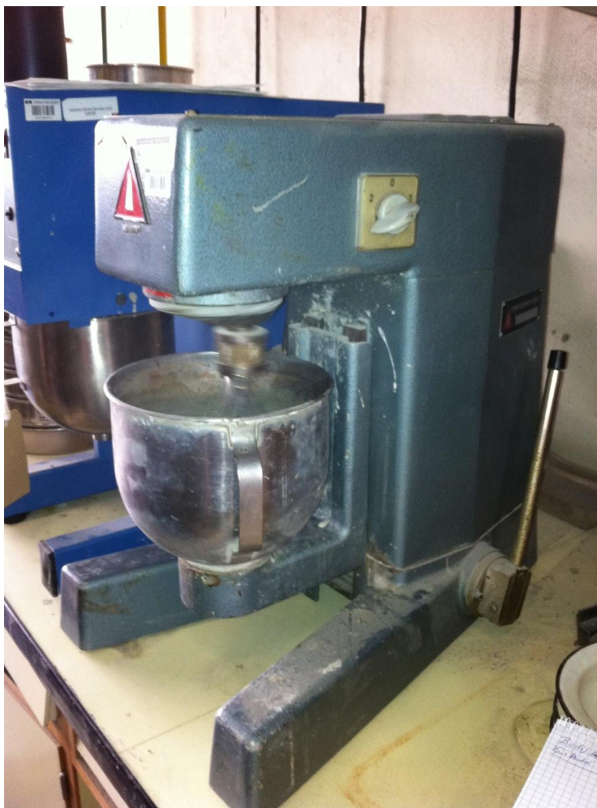
13. ábra a habarcs megkeveréséhez használt keverőgép
