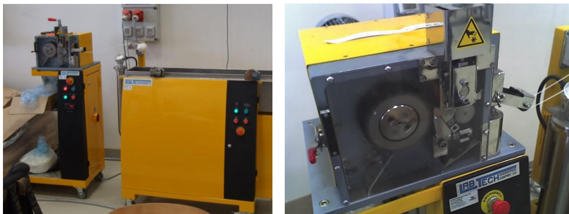
11. Az extruder követő berendezései: vízűtés és granuláló
