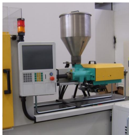
13. ábra: A Tanszék laboratóriumában található fröccsöntő berendezés
