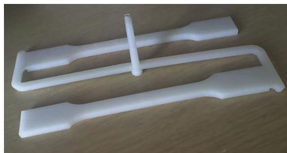
14. ábra: A fröccsöntéssel előállított próbatestek
