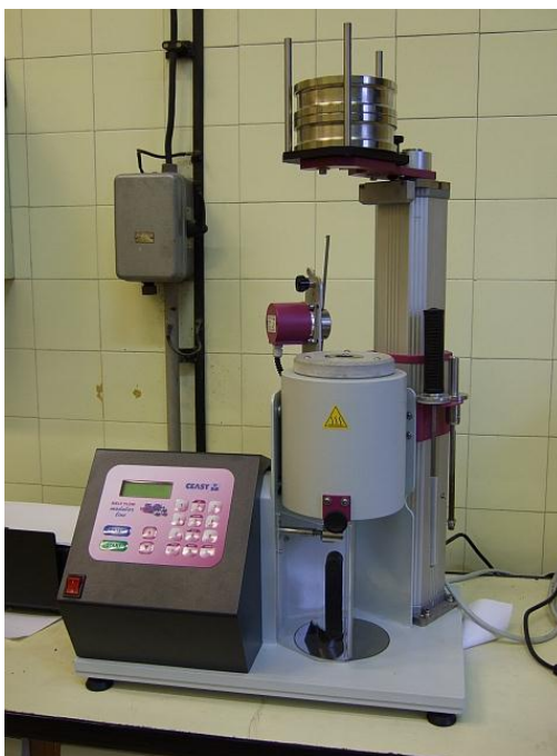
20. ábra: CEAST folyásindex-mérő berendezés
