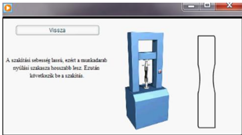
33. ábra Szakítóvizsgálat menetének részlete
