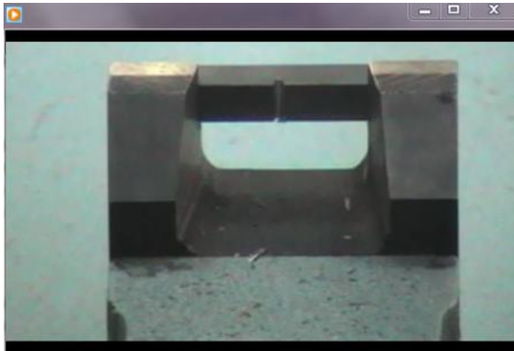
28. ábra Részlet a Charpy ütőmunka mérésének bemutatásából
