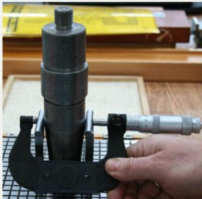
1.6.2 ábra: Külső kúp mérése mérőcsappal
