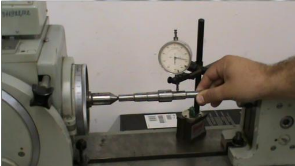
11. ábra Henger hengerességének vizsgálata mérőórával
