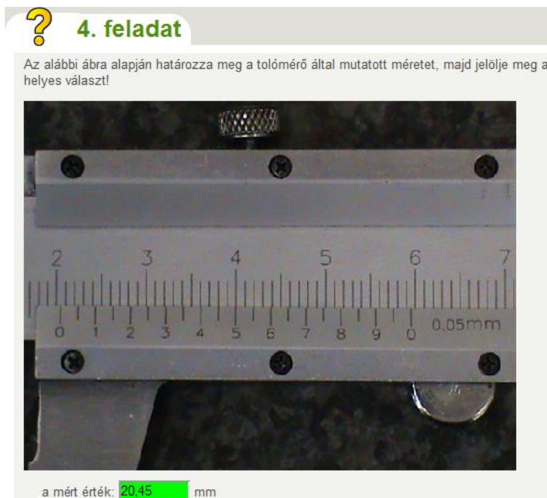
7. ábra A tolómérővel való méréshez tartozó feladat kiértékelése
