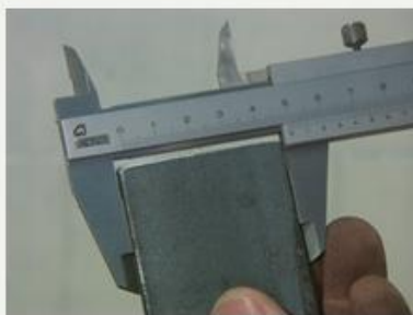
1.2.6 ábra: Munkadarab helyes befogása
