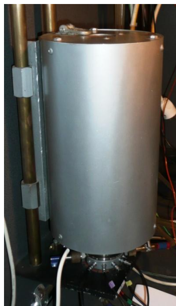
12. ábra A gázszenzorokra ráhúzott on-line vezérelhető, szabályozható hőmérsékletű és légterű kemence
