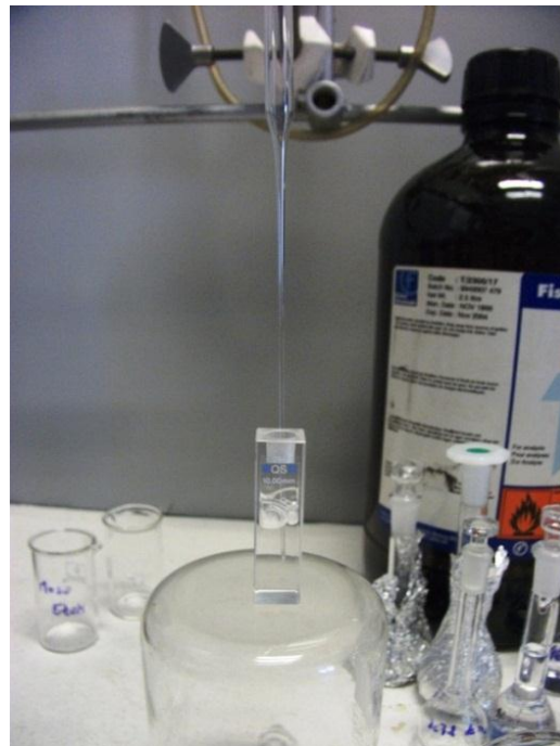
15. ábra: Csapokkal ellátott kvarcküvetta (balra), valamint oxigénmentesítés nitrogén gáz átbuborékolásával, kupakkal rendelkező küvettában (jobbra)
