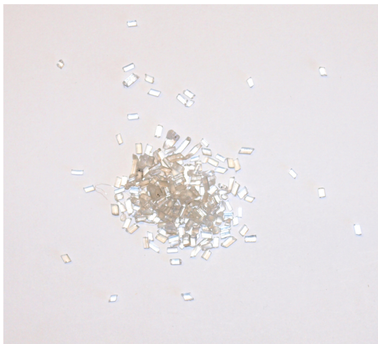
7. ábra A mérés során alkalmazott poli(etilén-tereftalát) minta (PET-02)
