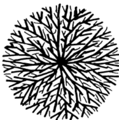
2. ábra. A szferolit szerkezete [7]
