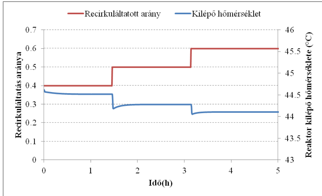
3.23. ábra: Kvensz anyagmennyiségének hatása a kilépő áram hőmérsékletére
