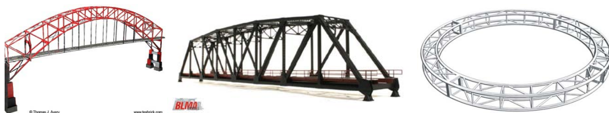
3.3. ábra: Példák rácsos tartókra, és olyan mérnöki szerkezetre, amely rácsos tartóként modellezhető. [9,10,11]
